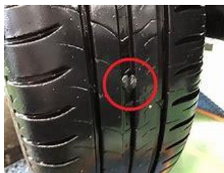
タイヤ亀裂損傷の有無・溝の点検
